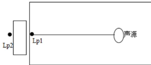
图 4-4 室内声源等效为室外声源图例
